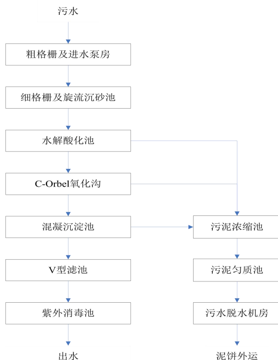
图 2.6-1 城东污水厂一期处理工艺流程图
