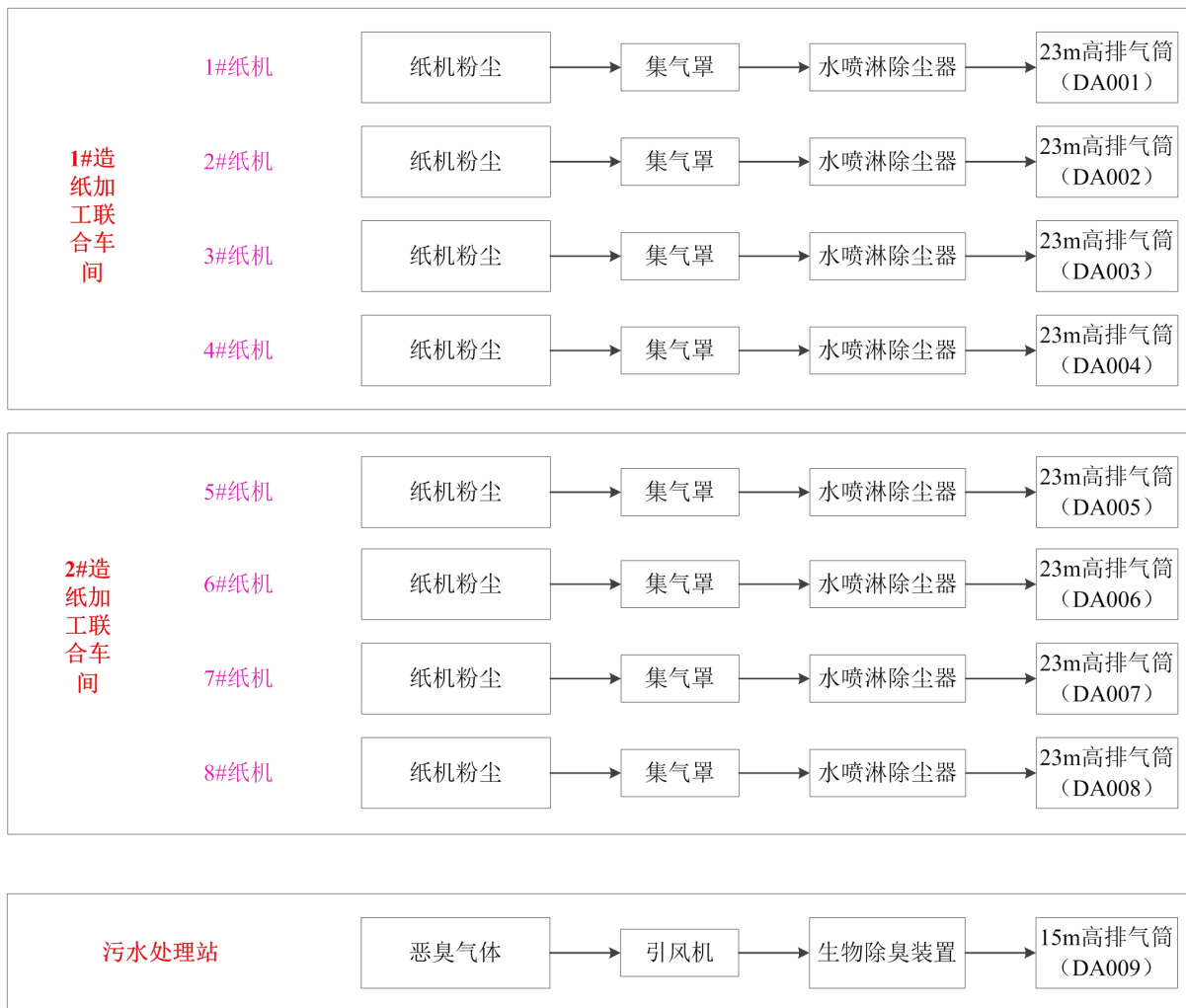
图 6.2-1 本项目废气收集及处理汇总示意图
