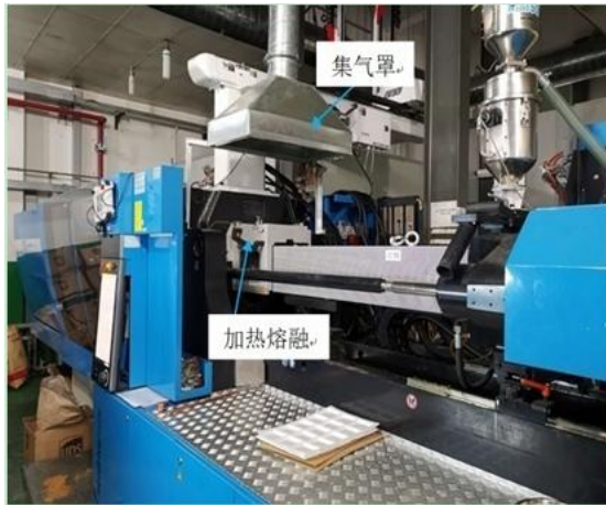
图 6.2-2 本项目注塑废气收集示意图（参照实列）
