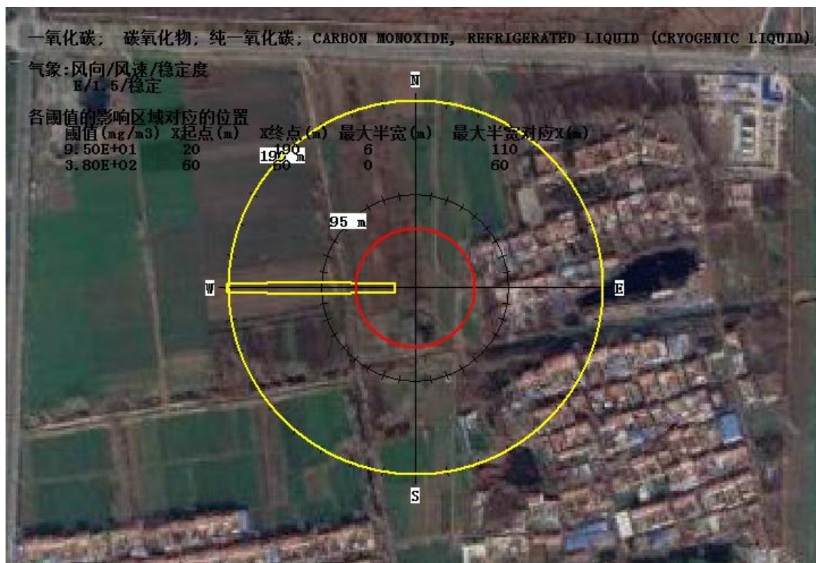
图 6.8-14 预测浓度达到不同毒性终点浓度的最大影响范围（最不利气象）
